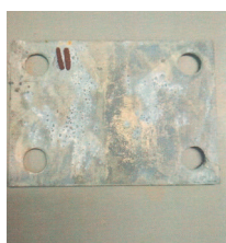
а) пластинки с горячеоцинкованным цинковым покрытием
