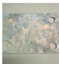
а) пластинки с горячеоцинкованным цинковым покрытием
