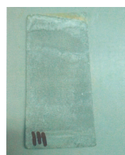
а) пластинки с термодиффузионным цинковым покрытием
