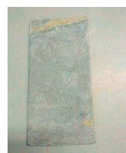
а) пластинки с термодиффузионным цинковым покрытием
