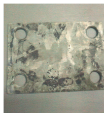
б) пластинки с горячеоцинкованным цинковым покрытием после удаления коррозии цинкового покрытия
