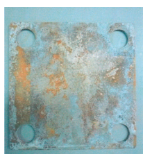
а) пластинки с гальваническим цинковым покрытием
